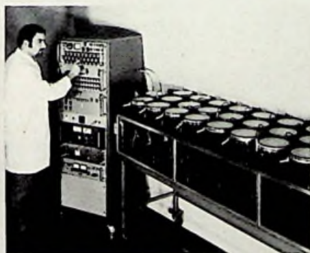
Oszillographen-Röhren in der Prüfung: Formieren der Kathode
