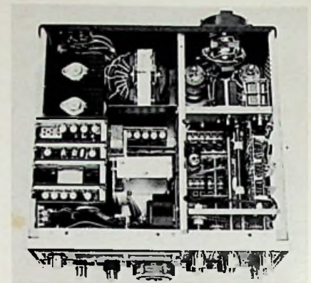
Bild 2. Blick auf das Chassis. Man erkennt hinten rechts den Ventilator und die beiden Senderöhren sowie die Drehkondensatoren des \pi -Filters, davor die Treiber- und Sendermischstufe mit den zwei 6-fach-Drehkondensatoren; links hinten Netztransformator und die Wandlertransistoren mit Kühlkörper, davor Steckmoduln und der VFO.
